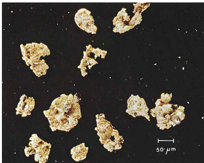
Рис. 2. Золото со следами транспортировки в аллювиальных потоках, извлеченное из образца В-Рифа, месторождения Лорейн Оранжевой Республики (Hallbauer, 1978)
