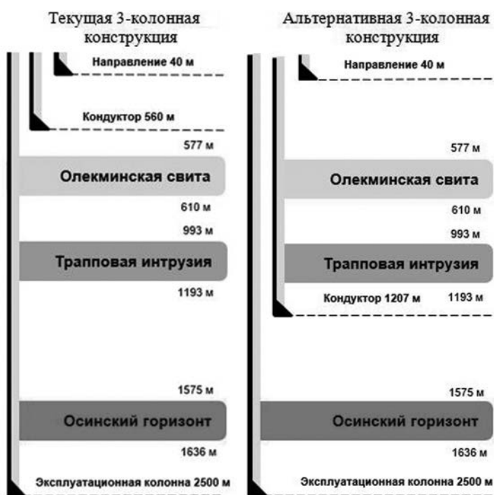
Рис. 4. Сравнение двух конструкций скважин
