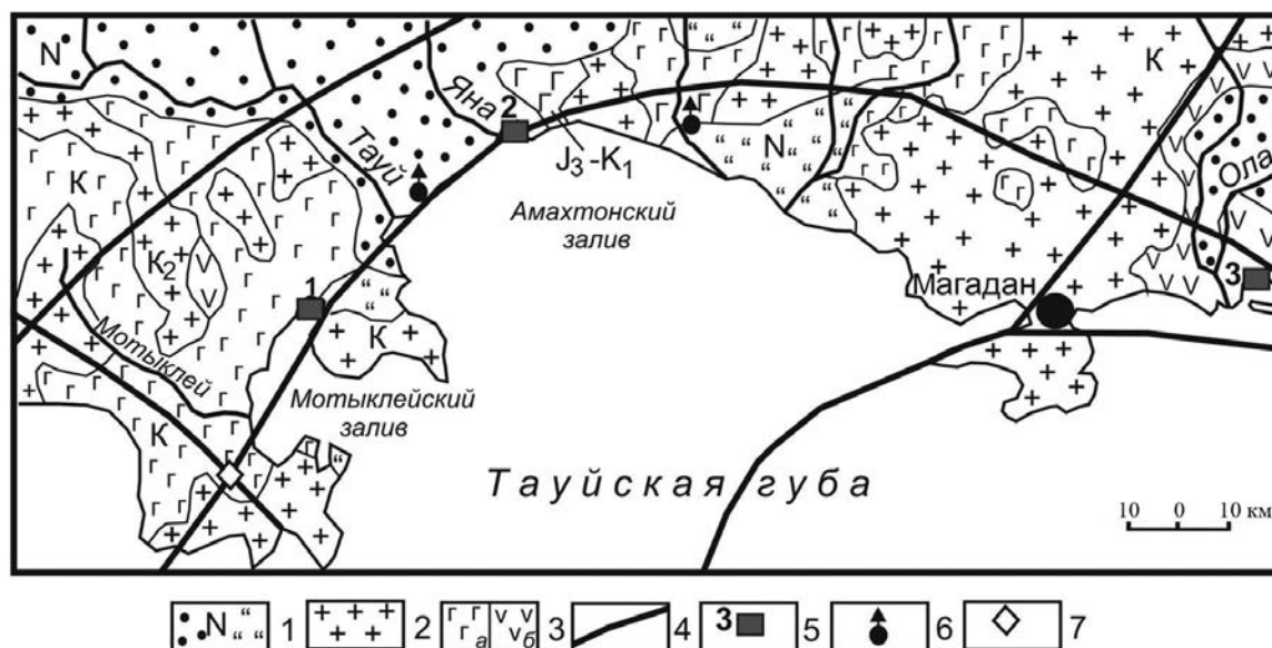
Рис. 2. Геолого-гидрогеологическая схема побережья Тауйской губы (обобщенная геологическая основа по В. Е. Королькову, А. М. Корольковой, 1992 г.; дополнена по В. Е. Глову, Л. П. Гловой, 2009 г.): 1 – нерасчлененные неогеновые отложения (чехол артезианского бассейна); 2 – гранодиориты, плагииграниты, монзониты мелового возраста; 3 – меловые вулканические породы среднего (а) и основного (б) состава; 4 – листрические разломы; 5 – скопления сульфидных илов, в т. ч. 1 – бух. Оджан, 2 – Янская лагуна, 3 – Ольский лиман; 6 – водогазопроявления; 7 – Мотыклейский термальный источник
