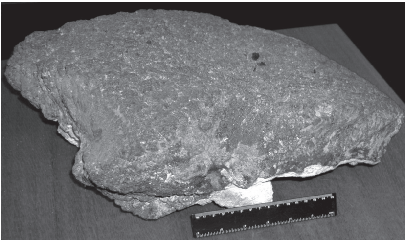
Рис. 2. Кобальтомарганцевая корка на рифогенном известняке. Гайот Вулканолог. Интервал драгирования 1800–1600 м
